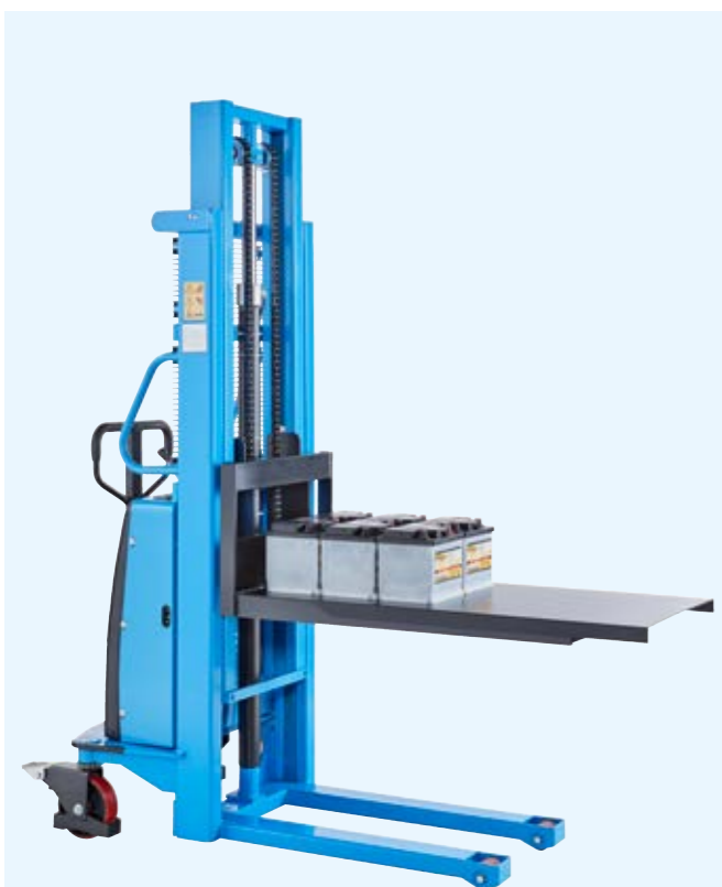
SDJ1025 mit Plattform PF Zum Kommissionieren unpalettierter Waren
