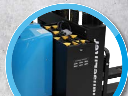
Durch das beidseitig zugängliche Wechselsystem lassen sich Batterien schnell und einfach tauschen.
