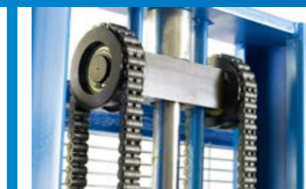
Solide Lastketten für optimale Hubeigenschaften
